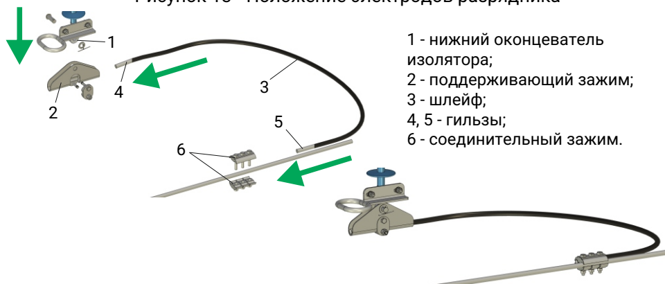
Рисунок 14 - Установка шлейфа
